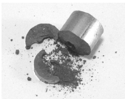
Рис. 5. Результат прессования в закрытой пресс-форме по традиционной схеме при давлении 1200 МПа с комбинированным применением смазок
